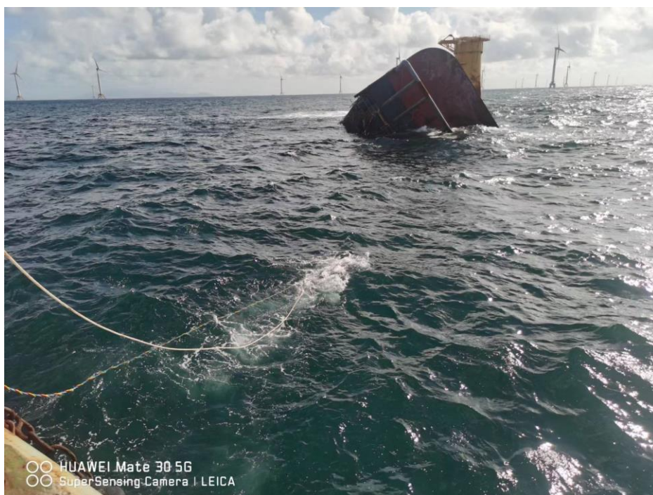
图 18 现场工作人员带缆作业
