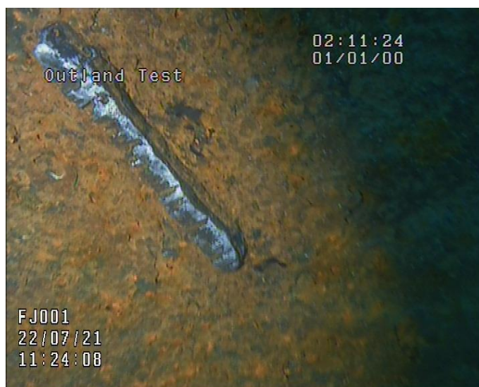
图 16. 主甲板面上的焊疤
